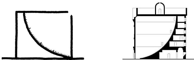
Figura 9.66 – Sección esquemática del espacio del arco graduado en el observatorio islámico-medieval.
