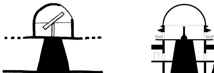
Figura 9.78 – Sección esquemática de sala del telescopio con cúpula y soporte macizo.
