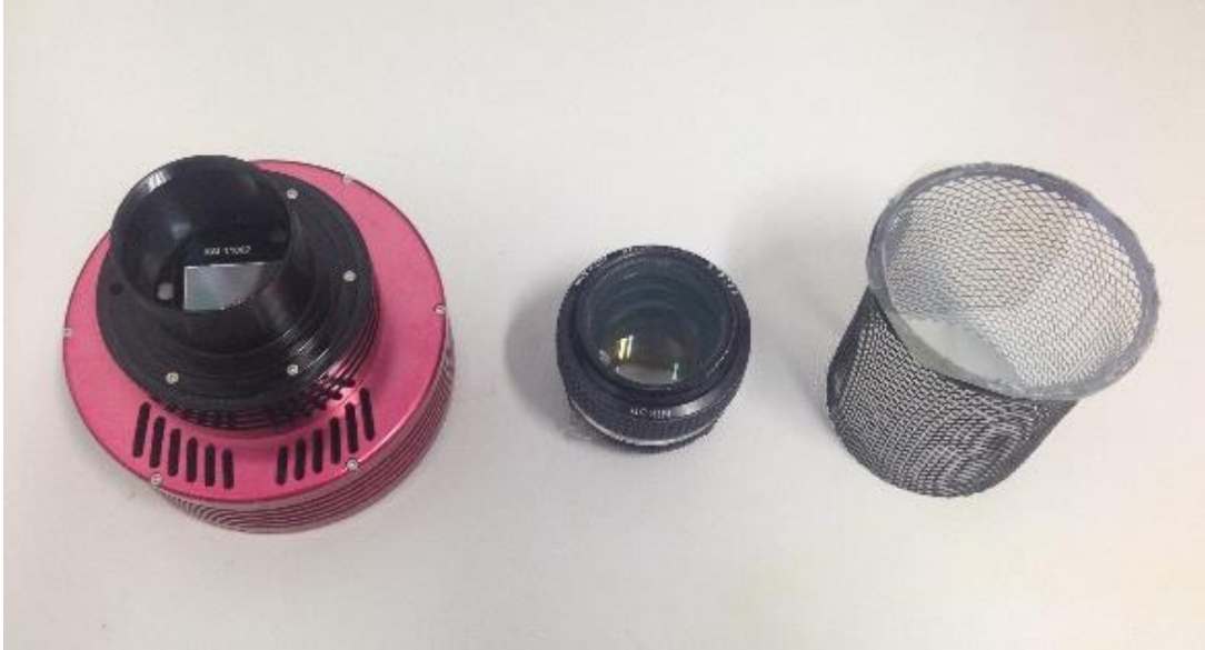
Figura 21. Sistema 2, compuesto de Atik 11000 +acoplamiento +objetivo Nikon 50 mm a f/1.2 y red de difracción con adaptador.
