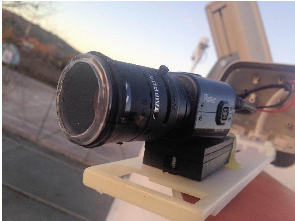
Figura 71. Cámara de video Watec con red de difracción incorporada, en el OAA.
