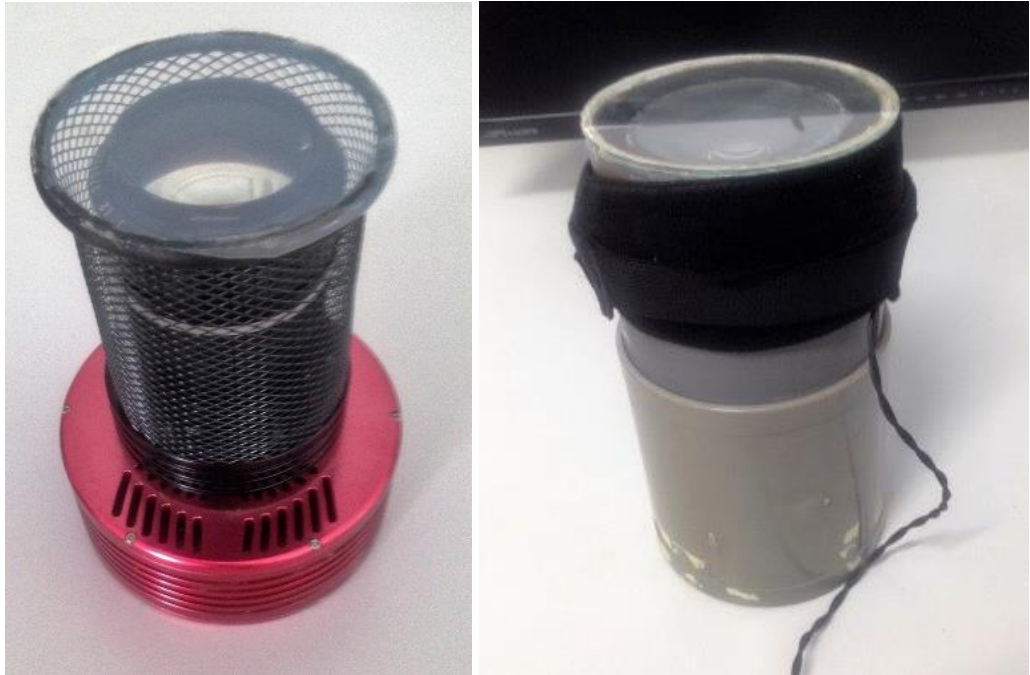
Figura 22. Espectrógrafo básico (izquierda) y con protecciones (derecha).
