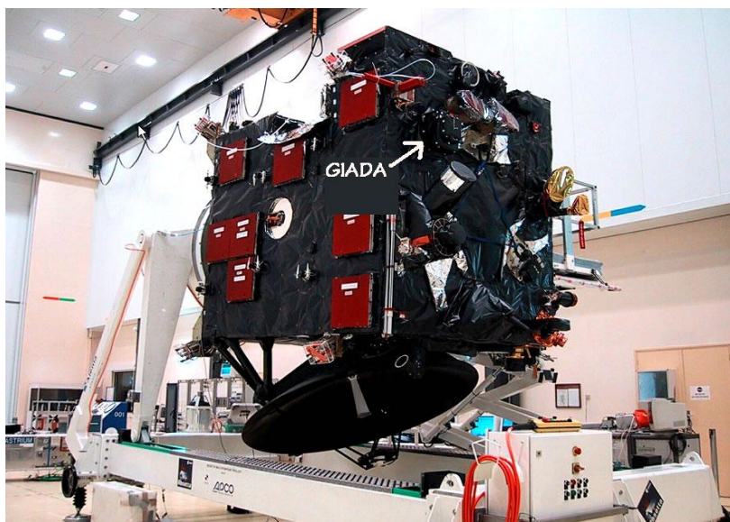
Ilustración 6. GIADA integrada en Rosetta en las instalaciones de ESA en ESTEC.
