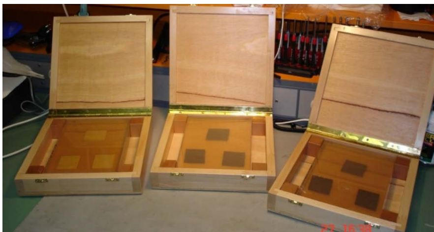
Imagen 5-12: Espejos de doblado sin recubrimiento a su recepción en noviembre de 2009.
