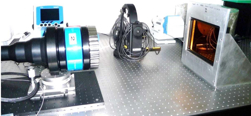
Imagen 5-18: Realizando el interferograma de superficie de M3 recubierto y en su montura preliminar.
