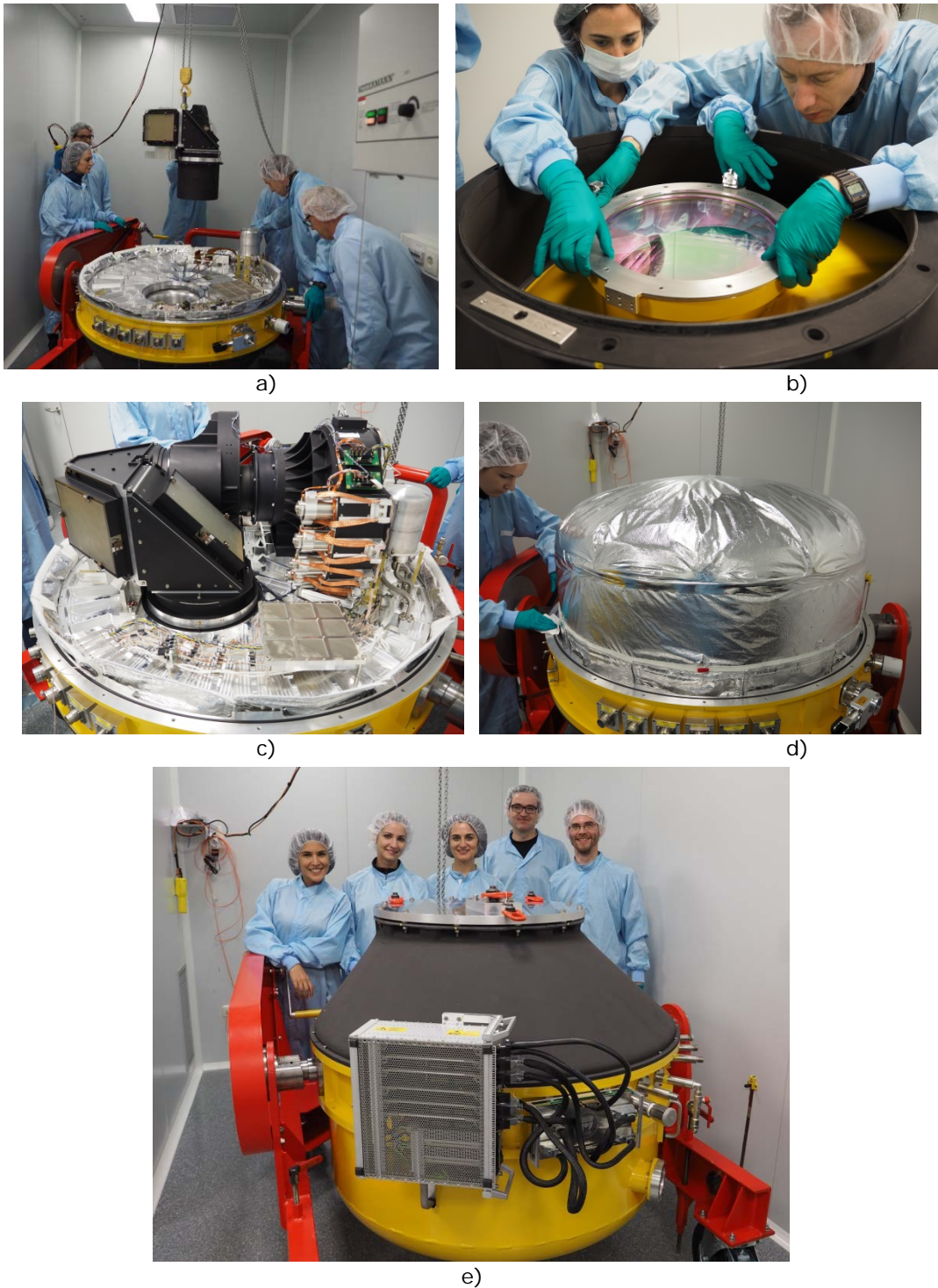
Imagen 5-67: Muestra de algunos pasos durante el reensamblaje del instrumento en la sala limpia de CAHA. a) Integración de la estructura OM1. b) instalación de la ventana de entrada del criostato. c) Instalada la OM2. d) Instalando el escudo de radiación del criostato. e) Equipo satisfecho y contento.
